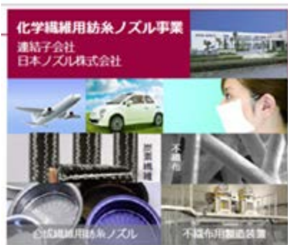
写真5:合成繊維用紡糸ノズル・・・ポリマー(高分子材料)に圧力を加えて押し出し、引っ張りながら糸を作る。装置と部品を提供する。
