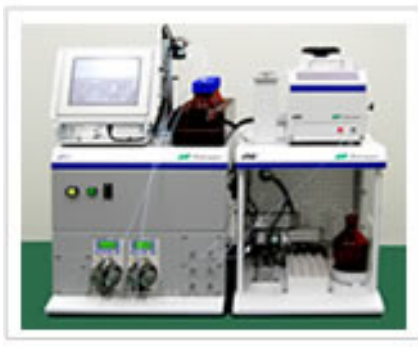
写真4: *4 マイクロリアクター 一辺あたり1mm以下の大きさの空間で連続的に化学反応を行う装置。(通常はバッチ反応器、いわゆる普通のフラスコなど)より大きなスケールで反応を行う他の装置と比べ、エネルギー効率、反応速度、安全性、対応できる反応、条件の制御能力などに優れている。
